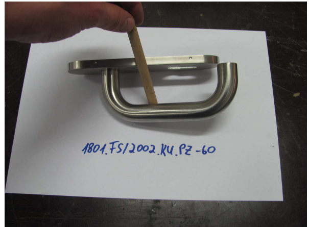
Bild 2 Ansicht des Probekörpers bei der Prüfung mit dem Prüfstab
