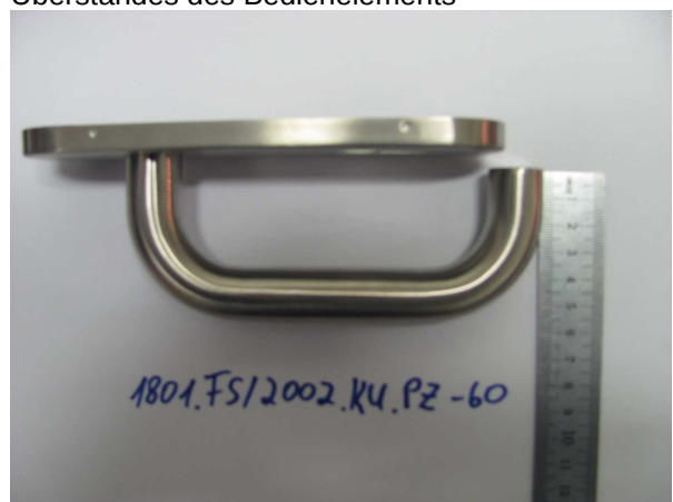
Bild 6 Ansicht des Probekörpers bei der Prüfung des Betätigungsabstandes des Drückers
