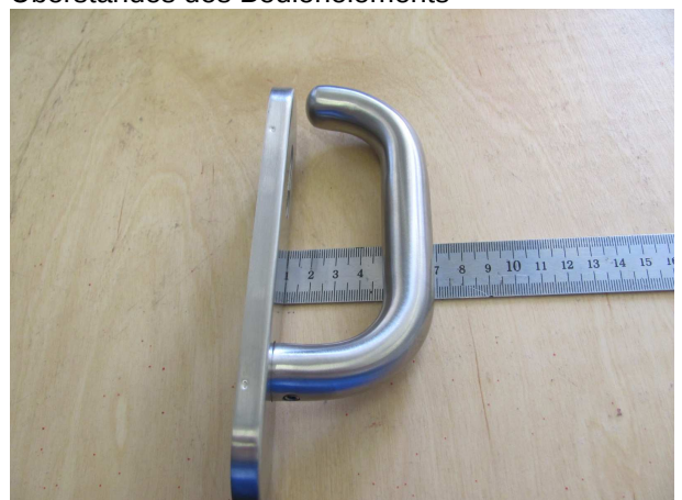
Bild 12 Ansicht des Probekörpers bei der Prüfung des Betätigungsabstandes des Drückers
