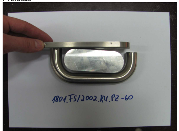
Bild 4 Ansicht des Probekörpers bei der Prüfung des Überstandes des Bedienelements
