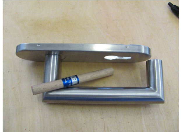
Bild 8 Ansicht des Probekörpers bei der Prüfung mit dem Prüfstab
