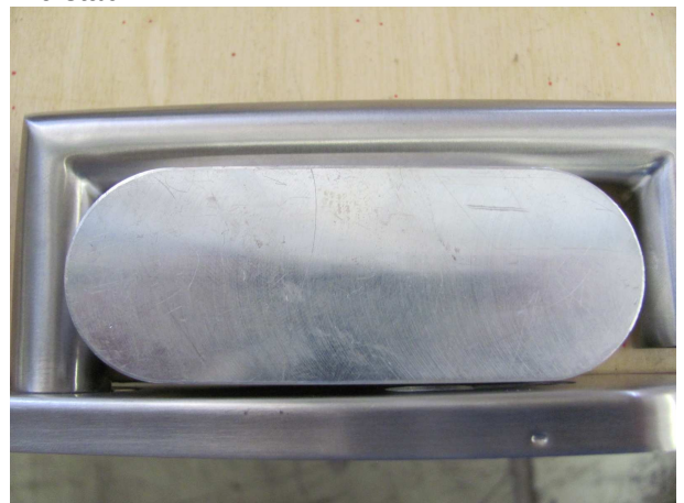
Bild 10 Ansicht des Probekörpers bei der Prüfung des Überstandes des Bedienelements
