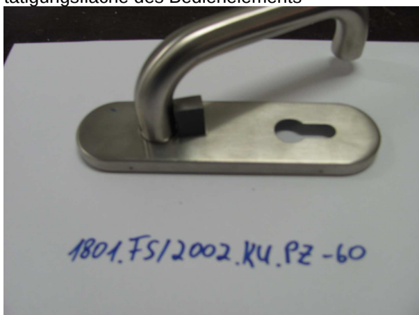
Bild 5 Ansicht des Probekörpers bei der Prüfung vom freien Ende des Drückers
